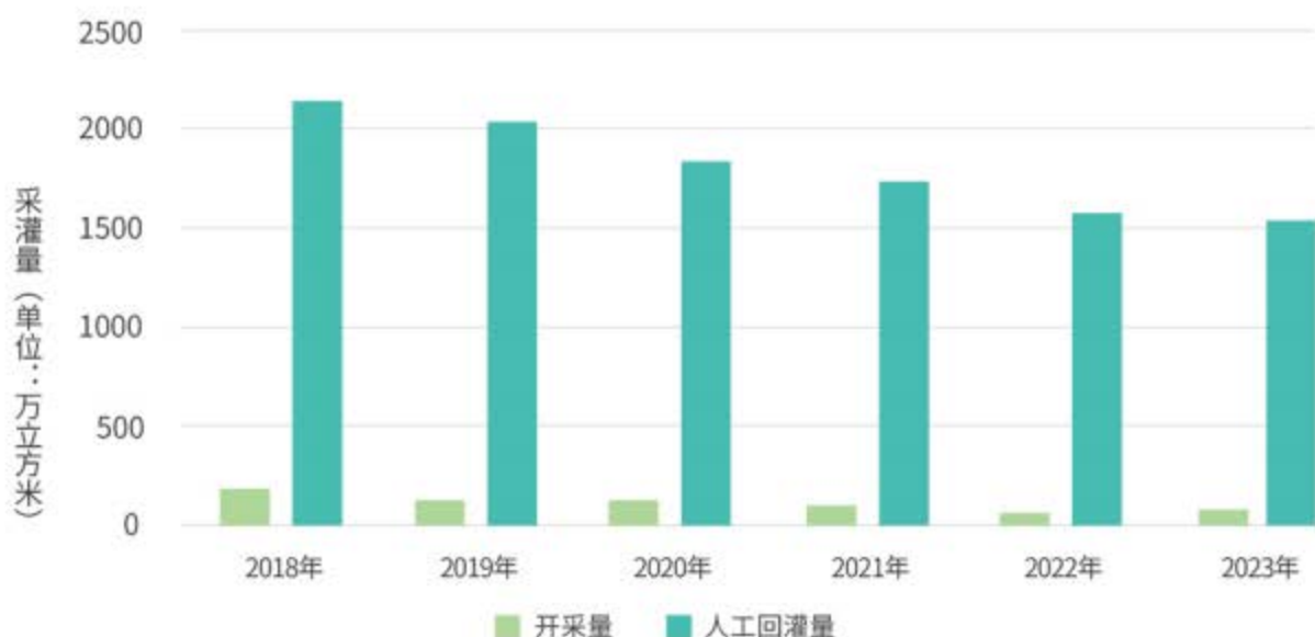
图6 上海市深层地下水开采量和人工回灌量年际变化图
